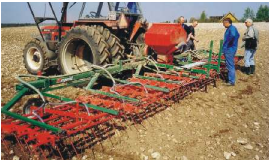
Joonis 9. Mullaharimise külvi põimagregaat peenseemnetele
