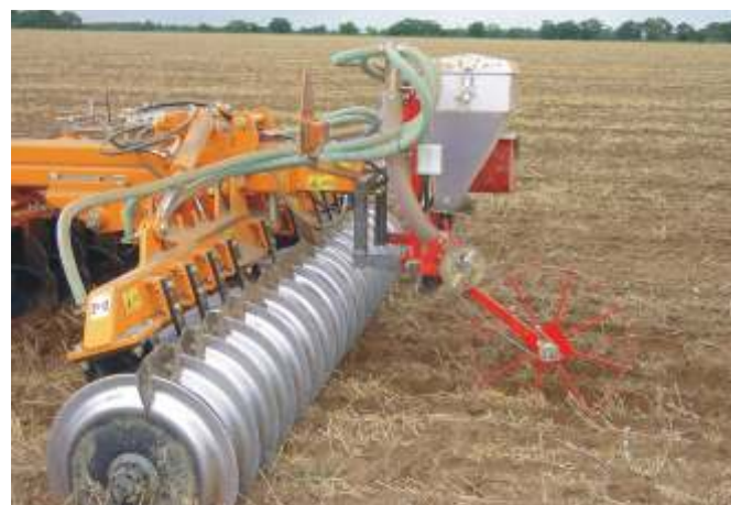
Joonis 8. Mullaharimise külvi põimagregaat peenseemnetele
